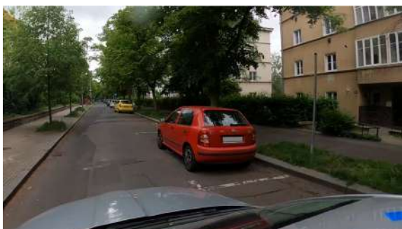
Obrázek 106: Deficit 061 - Neadekvátně označené parkovací místo pro ZTP - absence SDZ
