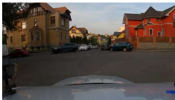
Obrázek 62: Deficit 029 - Nelegální parkování v prostoru křižovatky ovlivňující rozhledové poměry - víkend
