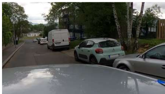
Obrázek 75: Deficit 040 - Nelegální parkování v prostoru sjezdu / samostatného sjezdu ovlivňující rozhledové poměry - všední den v pracovní době
