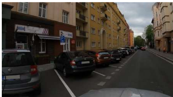
Obrázek 97: Deficit 052 - Neadekvátní provedení SDZ (dodatková tabule vlevo)
