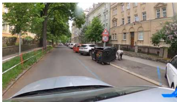
Obrázek 119: Deficit 073 - Nevhodné umístění nádob na odpad
