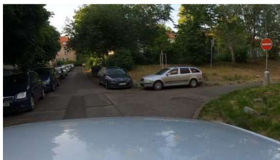
Obrázek 54: Deficit 025 - Nelegální parkování v prostoru křižovatky ovlivňující rozhledové poměry - všední den odpoledne
