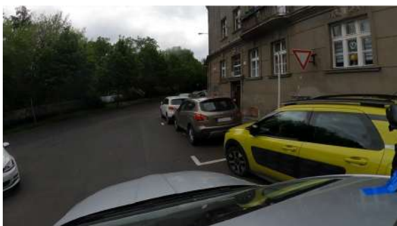
Obrázek 108: Deficit 062 - Neadekvátně označené parkovací místo pro ZTP - absence SDZ
