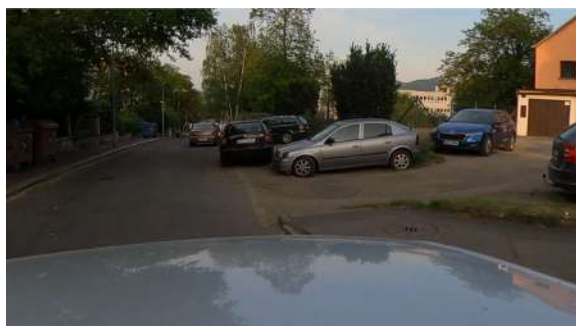
Obrázek 80: Deficit 042 - Nelegální parkování v prostoru sjezdu / samostatného sjezdu ovlivňující rozhledové poměry - víkend
